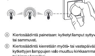
① Kiertosäädintä painetaan: kytkeytä lamput sytytys tai sammutta.
